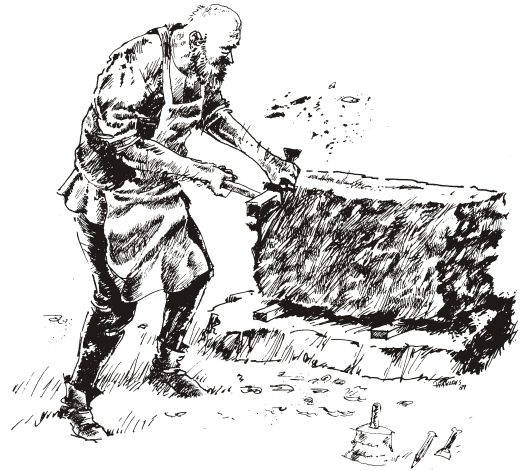
Absprengen entlang der angerissenen Linie
